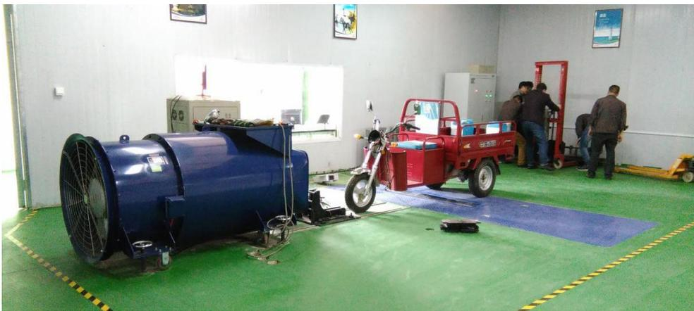
图 5 电动摩托车底盘测功机
