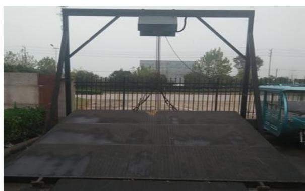
图2 侧倾角(驻车)试验台
