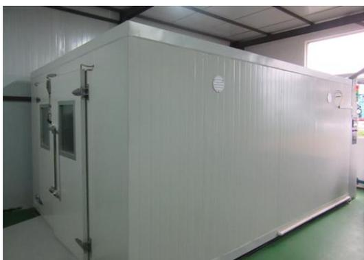
图1 步入式恒温恒湿试验室
